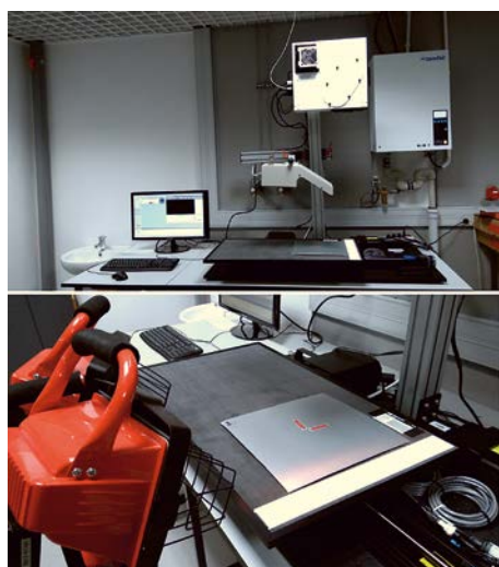
Rys. 1. Stanowisko do badań hiperspektralnych – układ ze standardowym oświetleniem od góry (góra) oraz układ z dodatkowym oświetleniem bocznym (dół). Fig. 1. Hyperspectral test rig – standard illumination from above (up) and an additional light source (down).
