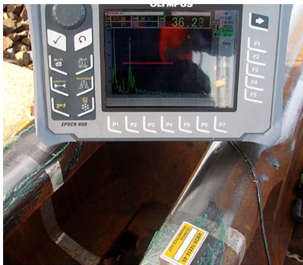
Rys. 15. Badanie ultradźwiękowe połączenia trójmetalicznego szyn i krzyżownicy Fig. 15. Ultrasonic examination of a three-metal joint of rails and a cross
