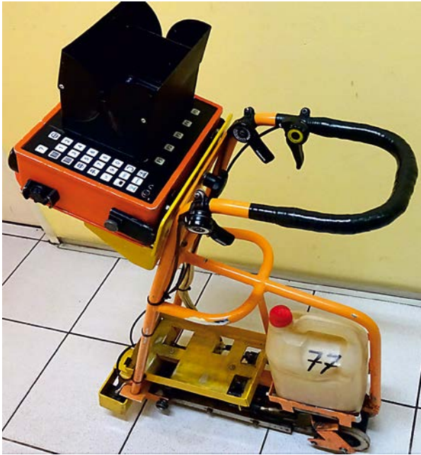
Rys. 14. Wózek RDM-12 do badań UT szyn kolejowych Fig. 14. RDM-12 trolley for UT testing of railway rails
