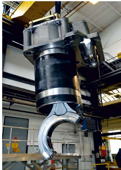
Rys. 9. Zestaw tłoka z korbą korbowodu z dolną częścią głowicy Fig. 9. Piston with connecting rod crank with the lower part of the head
