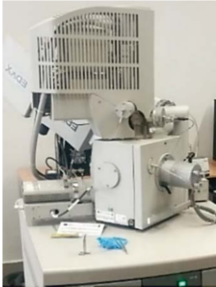
Rys. 3. Widok elektronowego mikroskopu skaningowego SEM do obserwacji kontrastu techniką BSE
