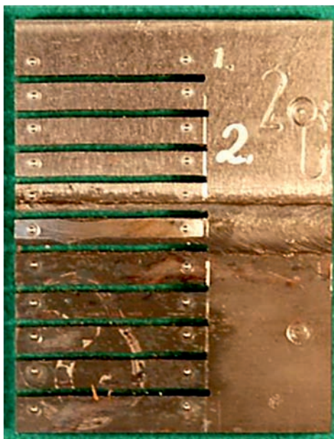
Rys. 2. Obraz wycinka PT z próbki P2 dla badań trepanacyjnych Fig. 2. Picture of part PT used for trepanation method extracted from sample P2
