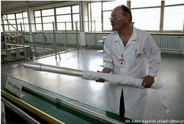
Rys. 8. Koszulka elementu paliwowego. Fig. 8. Coating of the fuel rod.
