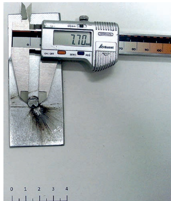
Rys. 5. Pomiar średnicy jądra zgrzeiny.
