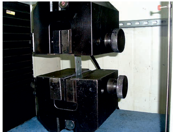
Rys. 4. Próbkę zamocowana w szczękach maszyny wytrzymałościowej.
