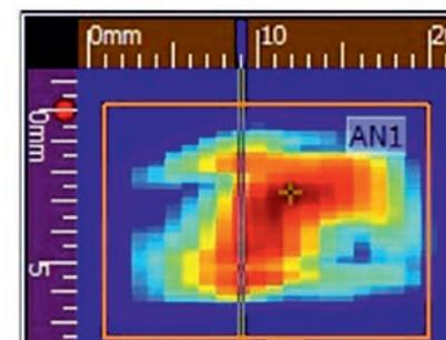
(d) TFM L-L image - encoded top view
