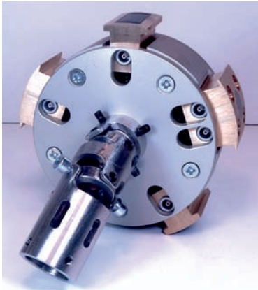
Rys. 12. Sonda badawcza z głowicami na fale powierzchniowe [10] Fig. 12. Research probe with heads for surface waves [10]
