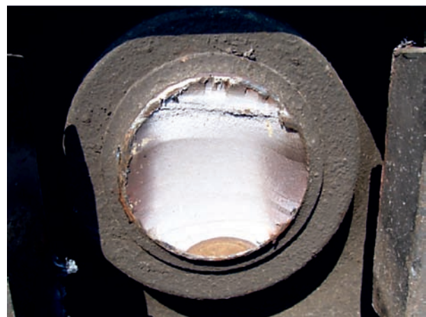
Rys. 1. Widok przełomu pęknięcia zmęczeniowego osi kolejowej. Fig. 1. View of the breakthrough of fatigue crack of railway axle.
