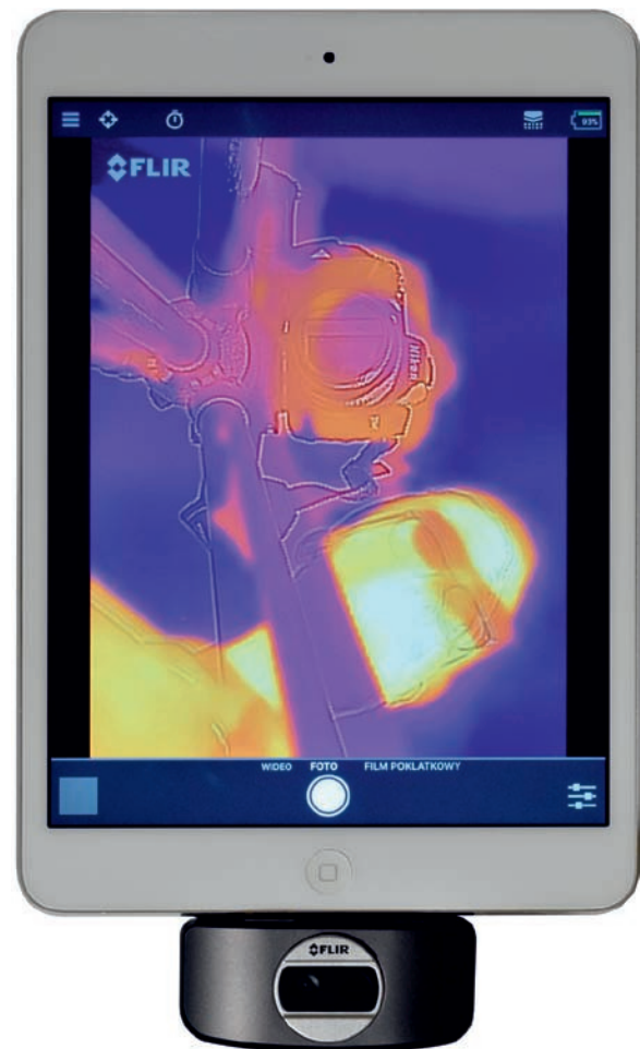
Rys. 1. Kamera termowizyjna Flir One podłączona do tabletu iPad mini. Dzięki symetryczności złącza Lighting, kamerę można zamontować w jednym z dwóch kierunków – w stronę operatora lub przeciwnie do niego.
