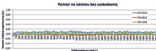
Rys. 10. Pomiar liny na odcinku bez uszkodzenia. Fig. 10. Measurement of the rope on the section without damage.
