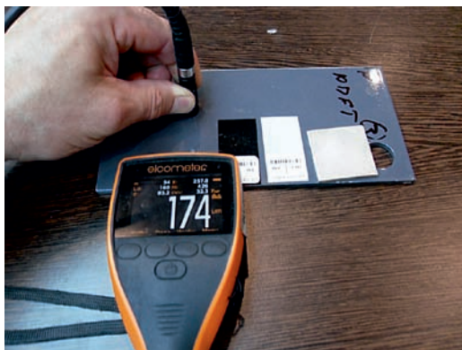
Rys. 15. Grubościomierz elektroniczny. Fig. 15. Electronical gauge.
