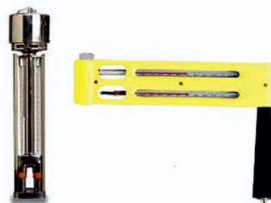
Rys. 8. Psychrometr aspiracyjny oraz psychrometr wirnikowy. Fig. 8. Aspirational psychrometer and rotary psychrometer.
