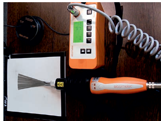
Rys. 17. Miernik wysokonapięciowy (poroskop). Fig. 17. High voltage holiday tester.
