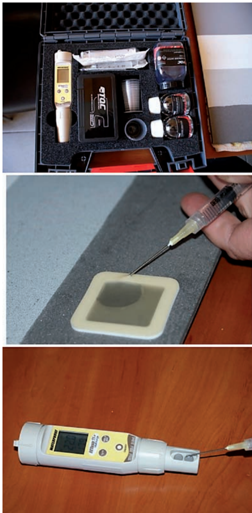
Rys. 5. Badanie metodą Bresle'a. Fig. 5. Bresley test method.
