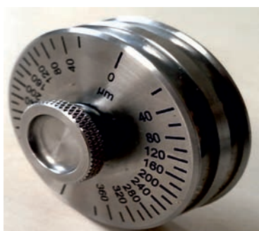
Rys. 10. Przyrząd krążkowy. Fig. 10. Wet film gage.
