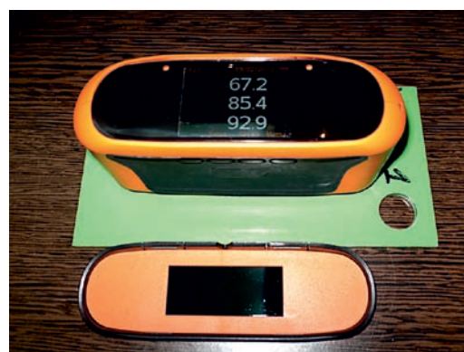
Rys. 13. Polyskomierz. Fig. 13. Gloss meter.
