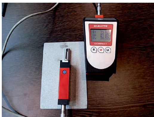
Rys. 3. Przyrząd stykowy. Fig. 3. Surface roughness tester.
