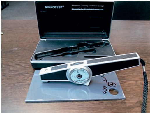
Rys. 14. Przyrząd magnetyczny. Fig. 14. Magnetic gauge.
