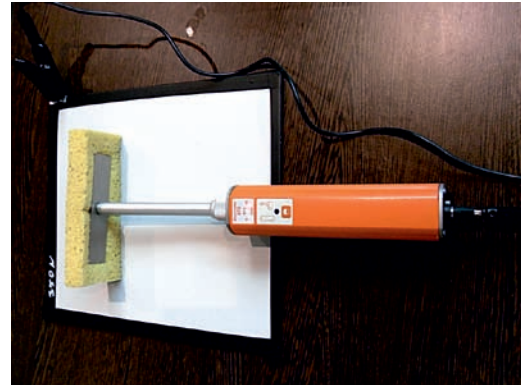
Rys. 16. Miernik niskonapięciowy (poroskop). Fig. 16. Low voltage holiday tester.
