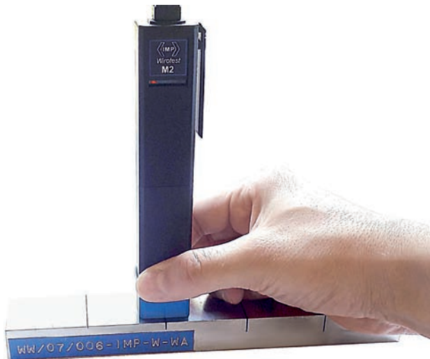
Rys. 2. Wirotest M2 z głowicą pomiarową – pomiar w trybie ręcznym. Fig. 2. The Wirotest M2 with measurement head – measurement in manual mode.
