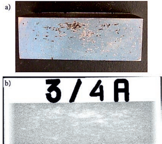
Rys. 4. Rzadziżny; kompozyt: zbrojenie – włókno glinokrzemianowe, osnowa: AlSi11; a – struktura kompozytu (badania makroskopowe), b – ten sam kompozyt – obraz cyfrowy z radiogramu (defektoskopia radiologiczna).
