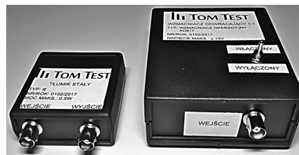
Rys. 2. Z lewej tłumik dopasowujący amplitudę impulsu nadawczego. Z prawej układ odwracający impulsy nadawcze defektoskopu ultradźwiękowego i dopasowujące go do standardu TTL
