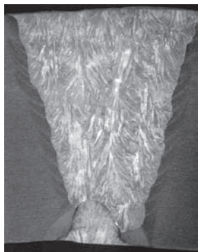
Rys. 1. Złącze spawane 9 % Ni – Inconel 625 - układ tekstury dendrytycznej spoiny austenitycznej w zbiornikach LNG
