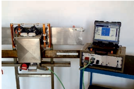
Rys. 24. Widok skanera Phased-Array w trakcie kalibracji na bloku referencyjnym
