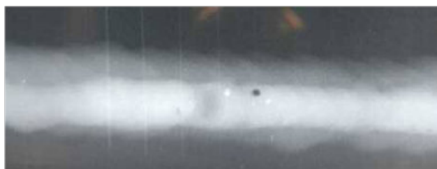
Rys. 8. Pęcherz oraz wtrącenie wolframu Fig. 8. Gas pore and tungsten inclusion
