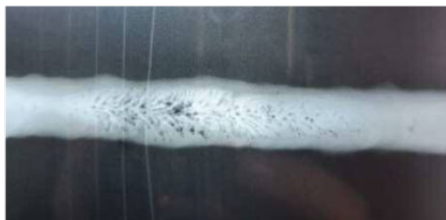
Rys. 9. Pęcherze kanalikowe Fig. 9. Wormholes
