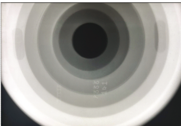
Rys.19. Obraz radiogramu koła zamachowego odlew żeliwny. **) Błona udostępniona przez PGO S.A. Odlewnia Żeliwa Oddział w Śremie.
