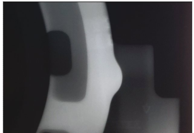
Rys.15. Obraz radiogramu obudowy wirnika odlew żeliwny. Fig. 15. Radiograph image of the rotor housing, cast iron.
