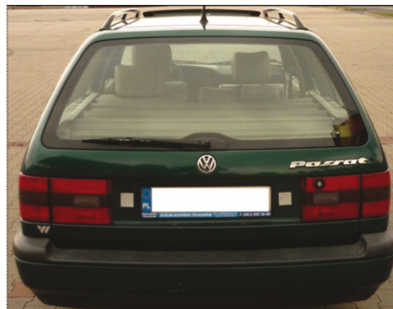
Rys. 4. Rozmieszczenie i oznakowanie punktów pomiaru drgań na tylnych drzwiach pojazdu
