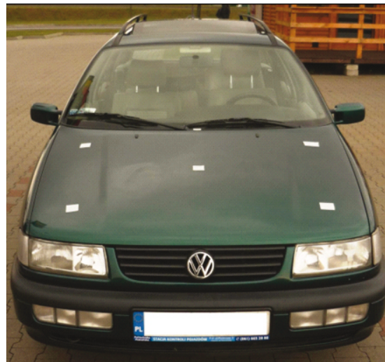
Rys. 3. Rozmieszczenie i oznakowanie punktów pomiaru drgań na masce pojazdu
