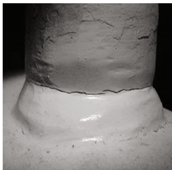
Rys. 2. Widok pęknięcia na trójniku. Fig. 2. View of the crack in the tee.
