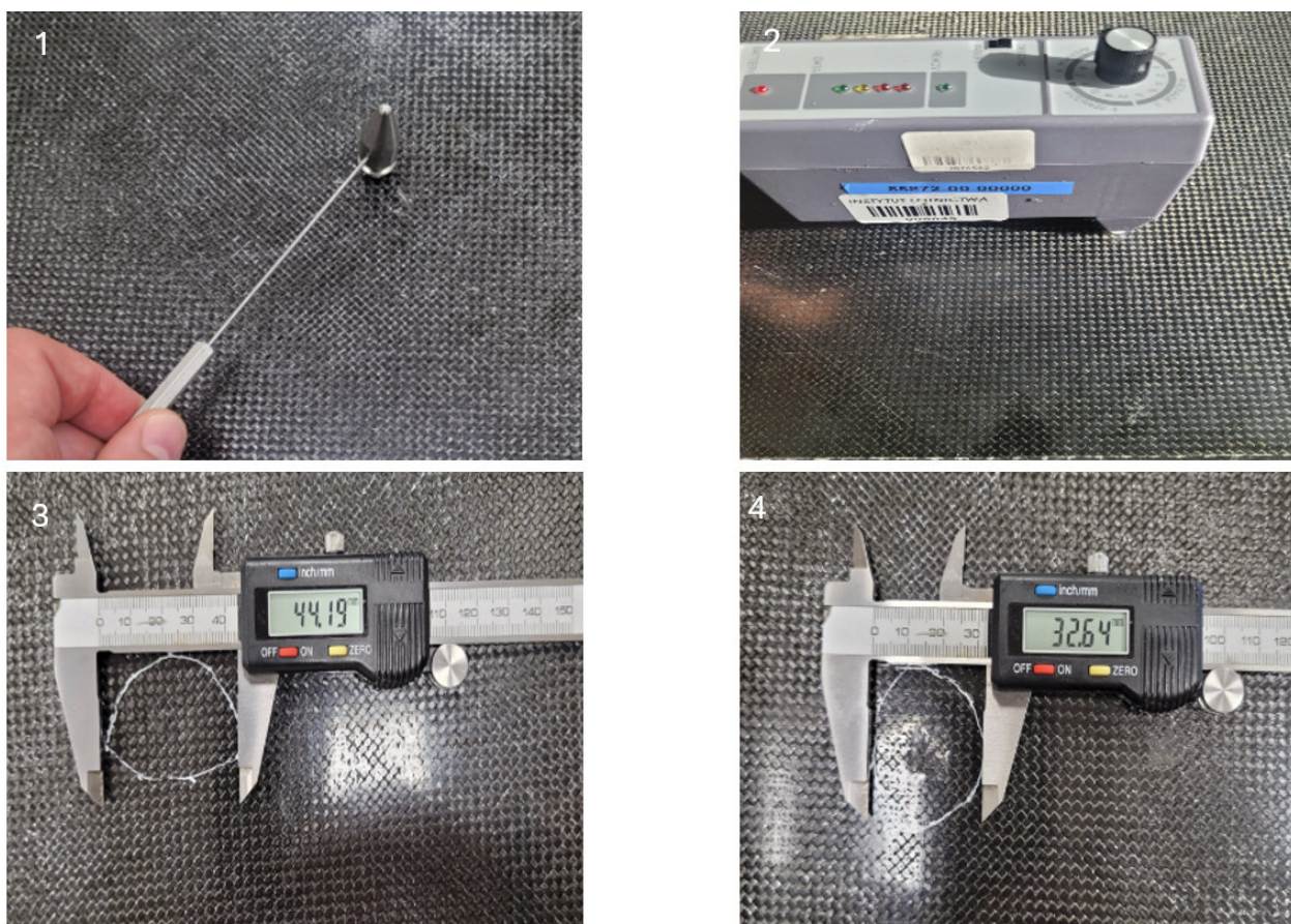
Rys. 11. Badanie przekładkowej struktury kompozytowej metodą tap-test: 1 – badania panelu za pomocą młotka, 2 – badania panelu za pomocą woodpeckera, 3 – wymiarowanie wykrytego uszkodzenia, 4 - wymiarowanie wykrytego uszkodzenia
