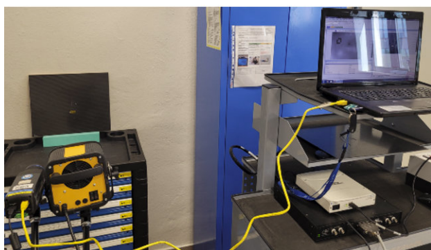
Rys. 12. Stanowisko badań termografii aktywnej Fig. 12. Active thermography research station
