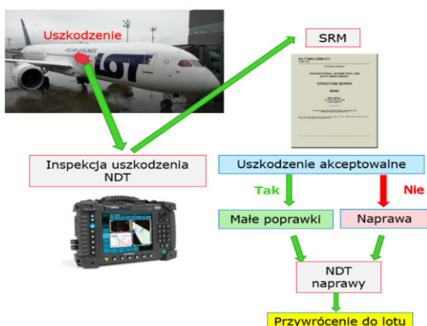
Rys. 6. Ogólne podejście do identyfikacji i naprawy uszkodzenia.
