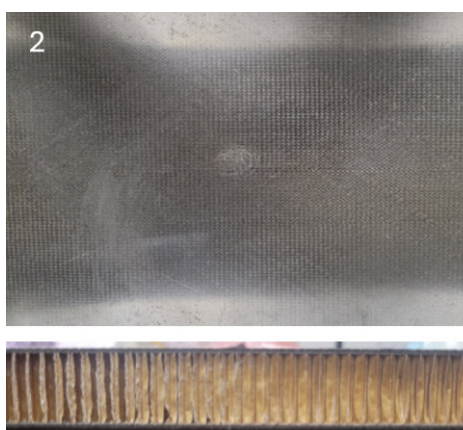
Rys. 7. Badane panele kompozytowe: 1 – panel laminarny, 2 – panel przekładkowy.
