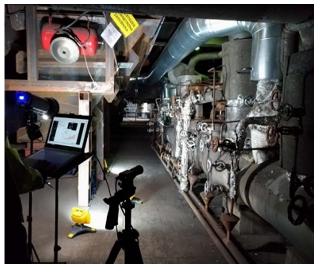
Rys. 8. Badanie kamerą wzmacniającą ruch/drgania.
