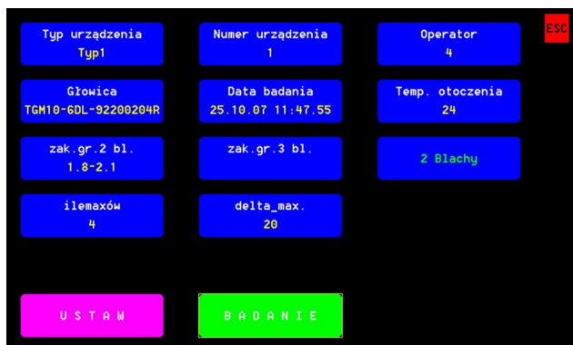
Rys. 6. Menu aplikacji do badania zgrzein punktowych firmy ZBM Ultra Sp. z o. o..
