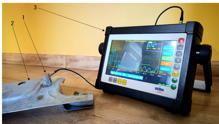
Rys. 4. Sprzęt do badania zgrzein punktowych firmy ZBM Ultra Sp. z o. o.; 1 – głowica ultradźwiękowa, 2 – próbka z połączeniami zgrzewanymi punktowo, 3 – defektoskop UT.
