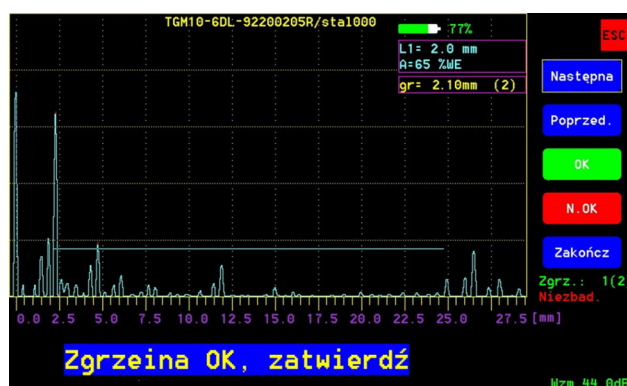
Rys. 8. A-scan (przebieg impulsów fali UT) przedstawiający zgrzeinę poprawną.
