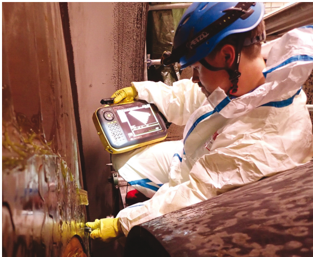
Rys. 7. Badanie Phased Array przeprowadzane ręcznie z powierzchni bocznej stopki łopaty, w celu wykrycia wad położonych najbliższej części wylotowej (Sonatest Prisma 16:64).
