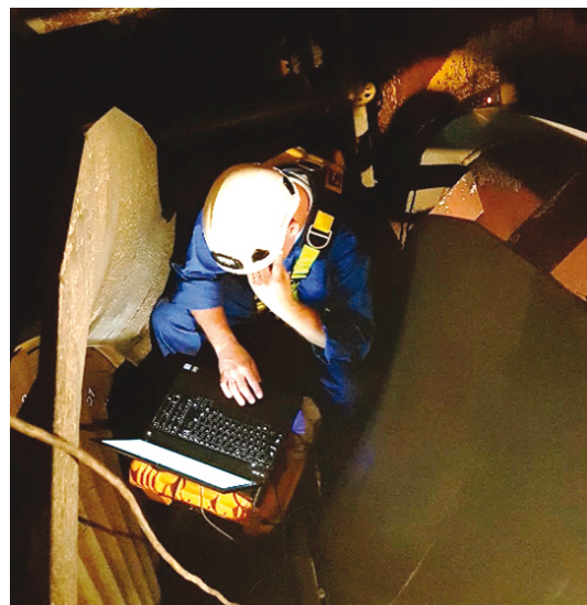
Rys. 3 Warunki panujące podczas badania stopek łopatek wirnika NP techniką Phased Array, przeprowadzane przez firmę Koli w zamkniętym układzie przepływowym turbiny
