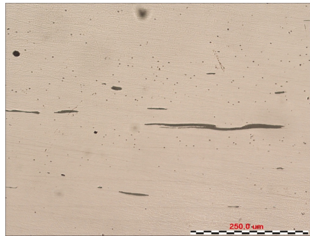
Rys. 5. Wtrącenia krzemianowe równoległe do osi wału oraz kuliste wtrącenia tlenkowe. Zgład nietrawiony (obiektyw10).
