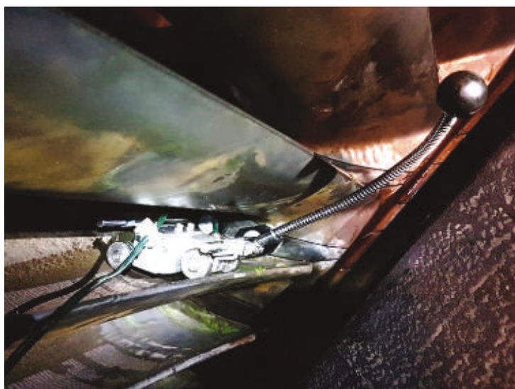
Rys. 3 Warunki panujące podczas badania stopek łopatek wirnika NP techniką Phased Array, przeprowadzane przez firmę Koli w zamkniętym układzie przepływowym turbiny
