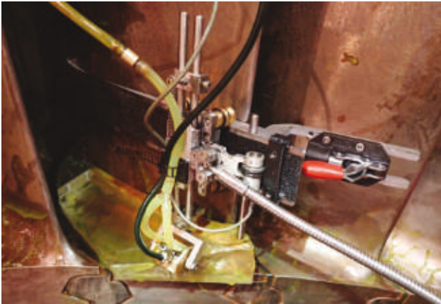
Rys. 6. Klin ciągły wraz ze skanerem, głowicą i enkoderem – system zamontowany na łopacie wirnika NP w elektrowni Forsmark.
