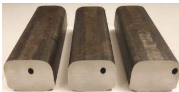
Rys. 6. Próbkę odniesienia do sprawdzenia wykrywalności wad typu 211.
