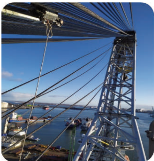
Rys. 1.2. Inspekcja MRT liny wysięgnika w systemie wielokrążkowym, dźwigu 5000T. Fig. 1.2. MRT Inspection of boom wire rope in multi-fall system, 5000T Crane
