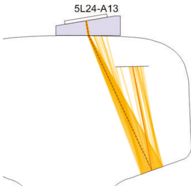
Rys. 13. Próbkki odniesienia z wadami sztucznymi do testowania głowic ultradźwiękowych projektowanych do wykrywania rozwiniętych wad typu H-C. Fig. 13. Reference samples with artificial defects for testing ultrasonic heads designed to detect developed H-C defects.
