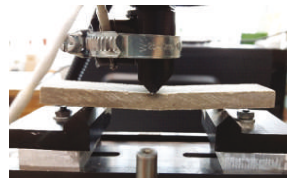
Rys. 5. Widok stanowiska badawczego do pomiarów metodą emisji akustycznej (po lewej) wraz z powiększeniem próbki płyty włókno-cementowej w trakcie badania (po prawej).
