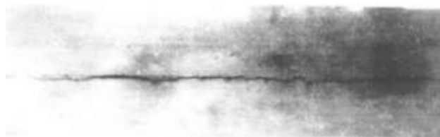
Rys. 18. Rentgenogram złącza czołowego środka z pęknięciem na całej długości styku
