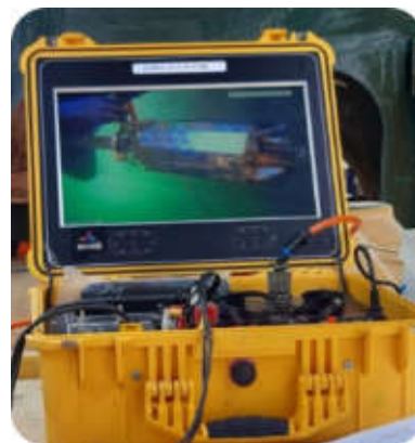
Rys. 3.6. Pierwsza na świecie inspekcja MRT lin pracujących pod wodą.
