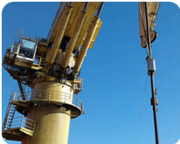
Rys. 1.1. Inspekcja MRT liny dźwigowej 128mm. Fig. 1.1. MRT Inspection of Crane Wire rope 128mm
