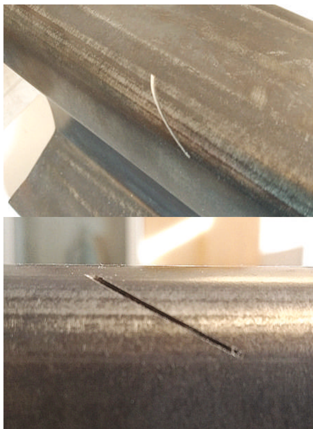
Rys. 7. Zobrazowanie wady nr 2223 - Head Checking. W górnym oknie obraz pęknięć na łuku toru, dolne okno widoczne pęknięcia na odcinku prostym.
