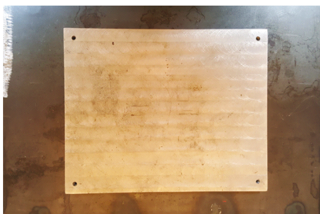
Rys. 5. Próbką referencyjną #15 do weryfikacji nastaw systemu ultradźwiękowego PA+TOFD.
