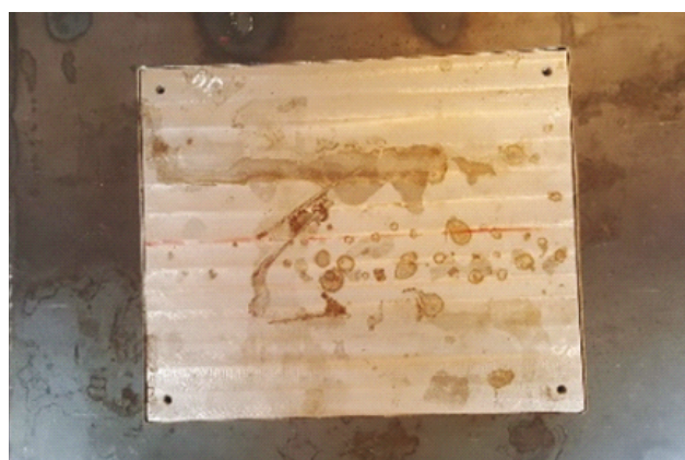
Rys. 6. Próbką referencyjną #28 do weryfikacji nastaw systemu ultradźwiękowego PA+TOFD
