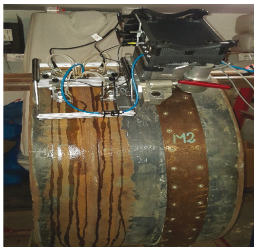
Rys. 1. Nowe rozwiązanie zmechanizowanego systemu PA+TOFD w wersji skanera zintegrowanego z aparatem Focus PX.
