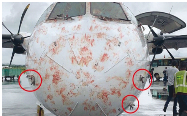
Rys. 5. Zderzenie samolotu pasażerskiego typu ATR-72 ze stadem ptaków [7].
