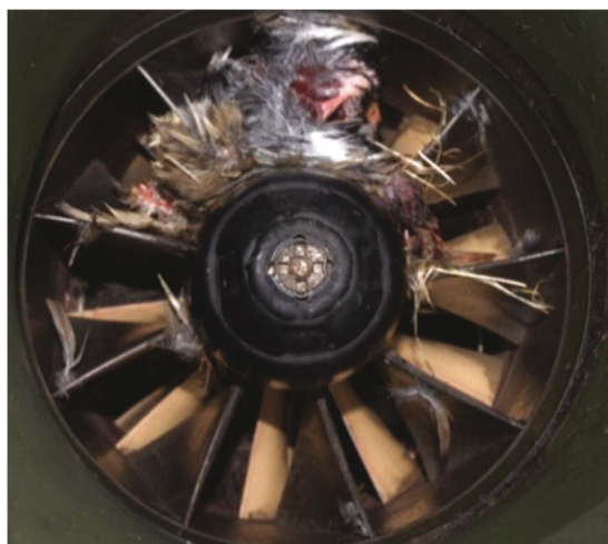
Rys. 6. Uszkodzenie sprężarki silnika odrzutowego [8].
