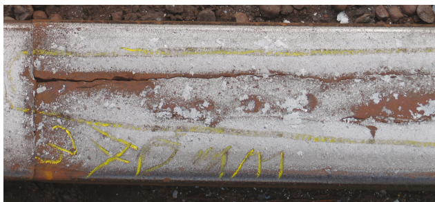
Rys. 3. Pęknięcie o długości 370 mm główki szyny torowiska podpory długiej po stronie zewnętrznej torowiska pomiędzy osiami 74-75 [1].
