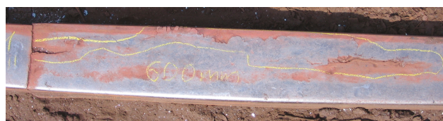
Rys. 6. Rozległy defekt o długości 600 mm będący prawdopodobnie wadą materiałową ze znacznymi deformacjami trwałymi główki szyny stwierdzony dla torowiska podpory długiej po stronie wewnętrznej pomiędzy osiami 80-81 [1].
