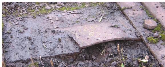
Rys. 7. Deformacja o strzałce f=85 mm oraz pęknięcie na ok. 40% przekroju płaskownika ustalającego szyny torowiska podpory krótkiej pomiędzy osiami 28-29 [1].
