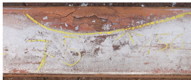
Rys. 4. Wykruszenia o długości 75 mm z deformacjami trwałymi główki szyny torowiska stwierdzone po stronie wewnętrznej torowiska podpory długiej pomiędzy osiami 75-76 [1].
