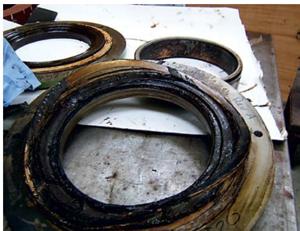
Rys. 10. Uszkodzone łożysko generatora Fig. 10. Generator bearing defective
