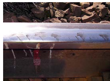
Rys. 2. Wada head check w stanie zaawansowanym [źródło własne] Fig. 2. Head check defect at the advanced stage [own source]
