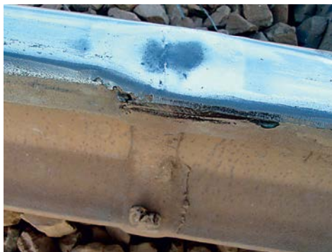
Rys. 10. Wada na złączu spawanym termitowo oznaczenie 422 Fig. 10. Defect on the termit welded joint designation 422
