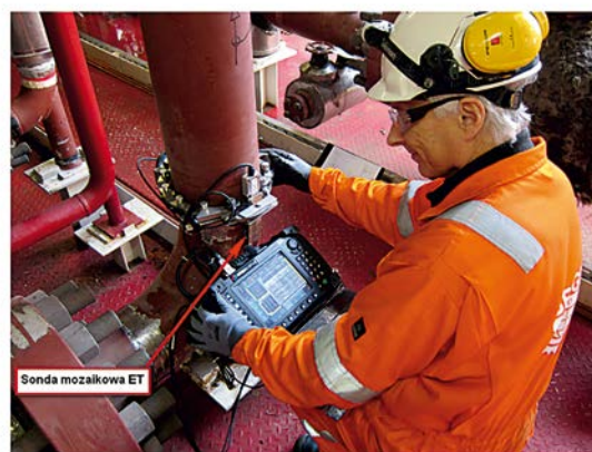
Rys. 8. Schemat lokalizacji sondy do skanowania i praktyczne badanie na rurociągu o średnicy 8 cali.
