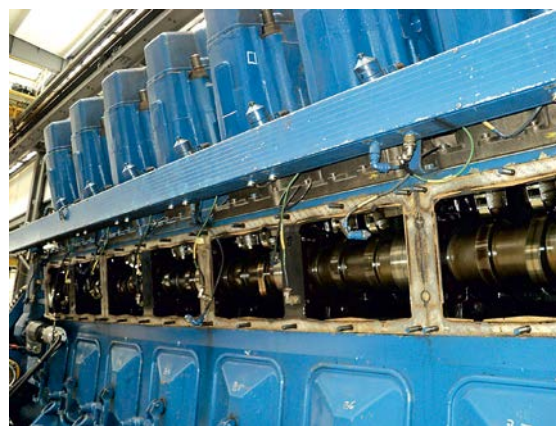
Rys. 8. Wał układu rozrządu silnika. Fig. 8. Engine timing shaft.
