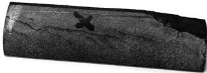
Rys. 4. Wada head check przygotowana do badań CT [źródło własne]
