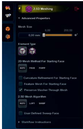
Rys. 6. Widok panelu „2.5D meshing” Fig. 6. „2.5D meshing” panel view
