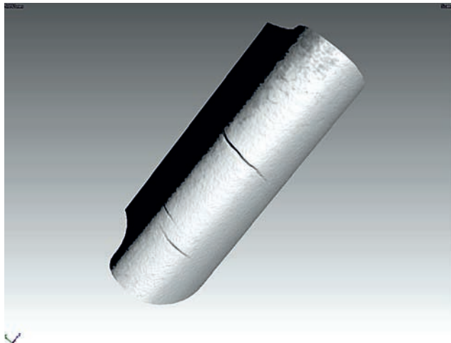
Rys. 5. Pęknięcia na krawędzi natarcia łopatki turbinowej uwiarydopodobnione podczas badania CT.
