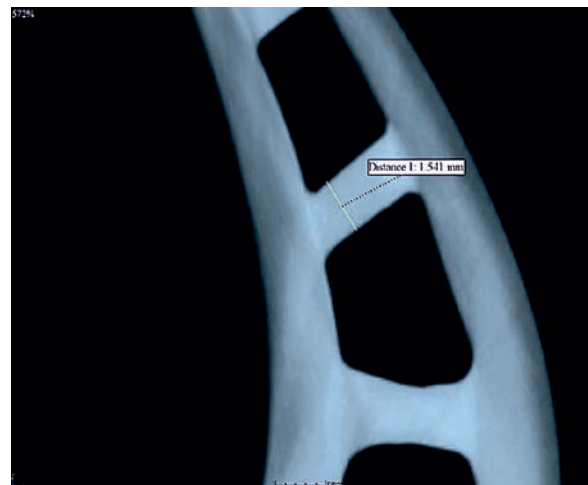
Rys. 4. Obraz geometrii wewnętrznych kanałów chłodzących łopatki turbinowej.
