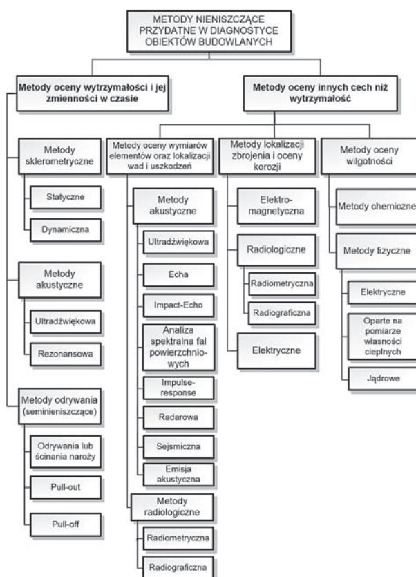
Rys. 1. Metody nieniszczące przydatne w diagnostyce obiektów budowlanych [4].
