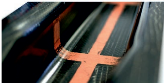
Fig. 12. Hut profile, upper with integrated SHM network. Rys. 12. Profil, górny ze zintegrowaną siecią SHM.
