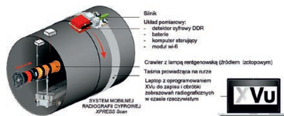
Rys. 2. Ogólny widok mobilnego systemu radiografii cyfrowej XPRESS Scan – 3Endt (skaner wraz z detektorem DDA) do badania złączy obwodowych rurociągów.
