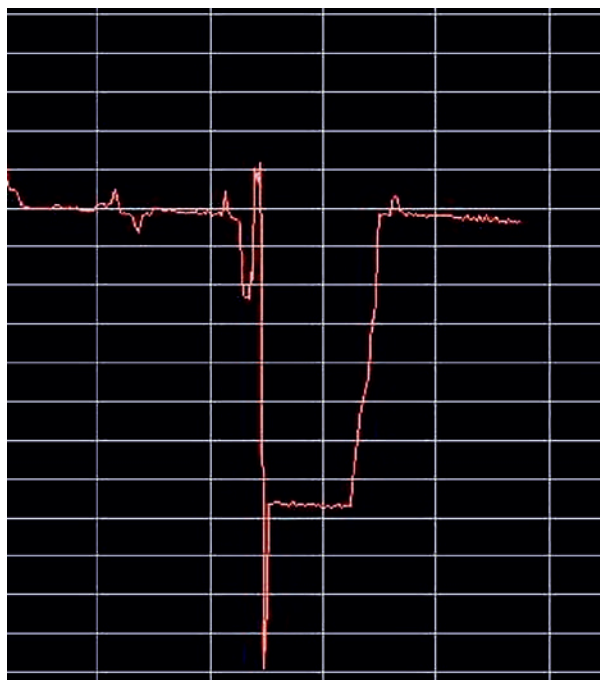
Rys. 3. Przykładowy przebieg różnicy ciśnień podczas badania szczelności.
