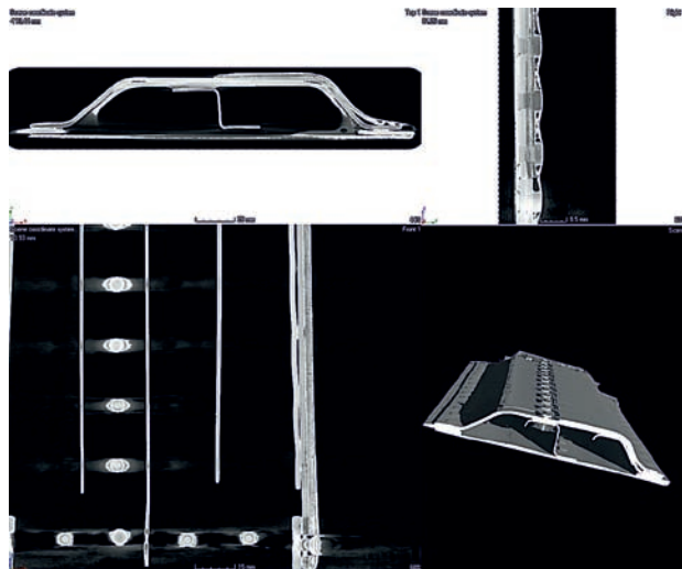
Rys. 8. Widok klapki aluminiowej z naniesioną powłoką kompozytową.
