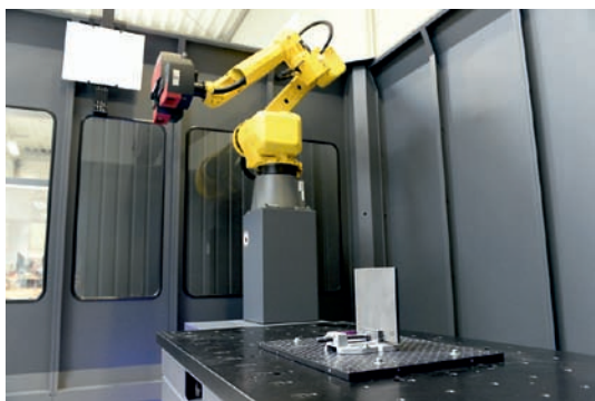
Rys. 4. GOM ATOS ScanBox serii 6 przygotowany do skanowania próbki zamocowanej w imadle.
