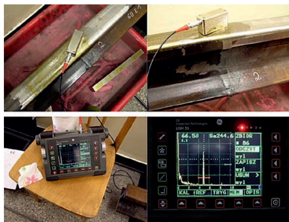
Rys. 2. Przykład wykorzystania ultradźwiękowej techniki echa [3].
