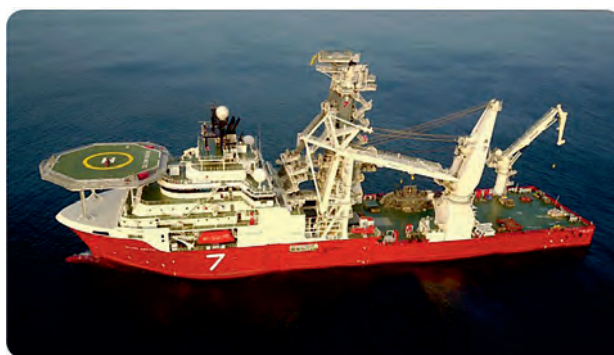
Rys. 15. Dźwig pływający 7 ARCTIC wyposażony w System Diagnostyczny LRM*XXI do badania lin o średnicach 106 i 136mm
