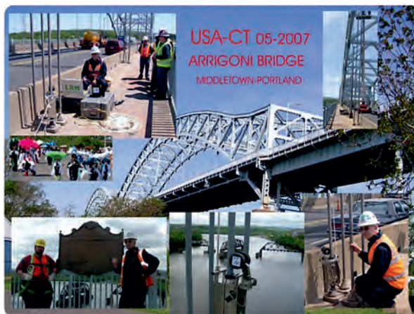
Rys. 10. Technologia LRM badania lin mostu wiszącego z konstrukcją stalową na rzece Connecticut
