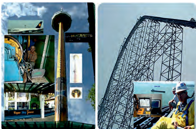
Rys. 14. Technologia LRM badania lin podnoszących ludzi
