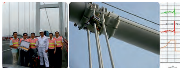
Rys. 9. Technologia LRM badania lin mostu wiszącego Tiger Bridge w Chinach
