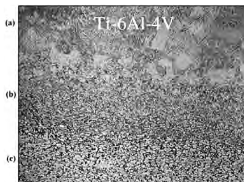
Rys. 2. Mikrostruktura stopu Ti-6Al-4V po nanoszeniu techniką LENS na podłożu Ti-6Al-4V: (a) stop przetopiony laserem, (b) strefa wpływu ciepła, (c) materiał podłoża [9]
