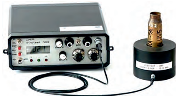
Rys. 3. Badanie łusek mosiężnych – Wirotest 302 z sondą przelotową
