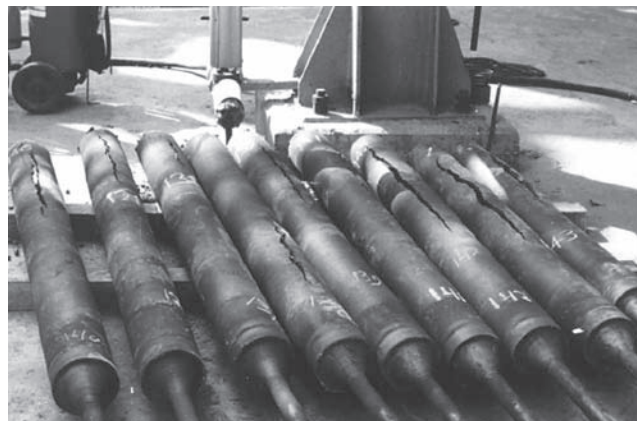
Rys. 2. Pęknięcia wzdłużne rur katalitycznych [13] Fig. 2. Longitudinal cracks of catalytic pipes [13]
