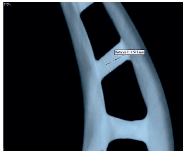
Rys. 4. Obraz geometrii wewnętrznych kanałów chłodzących łopatki turbinowej.
